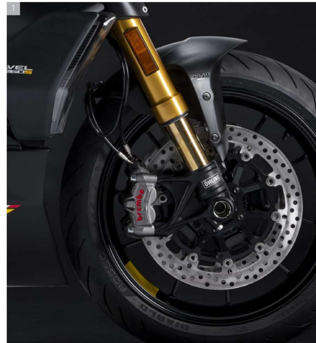
1 Suspensiones Öhlins con acabado dorado completamente regulables delante y detrás
