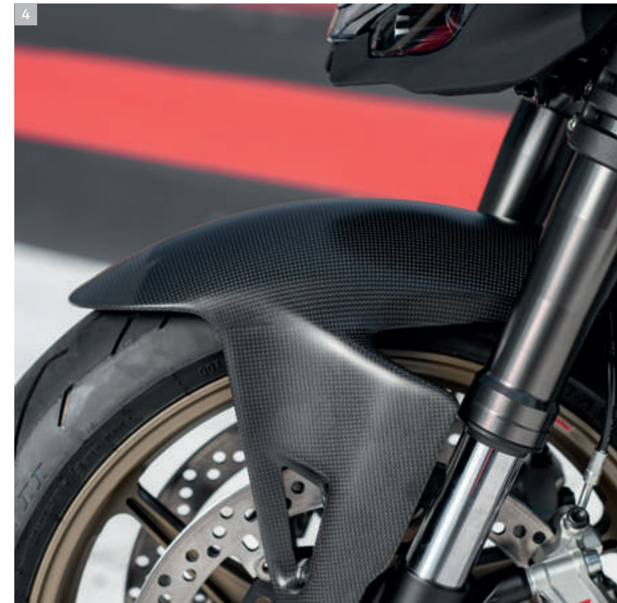
3 Guardabarros trasero de carbono. 4 Guardabarros delantero de carbono.
