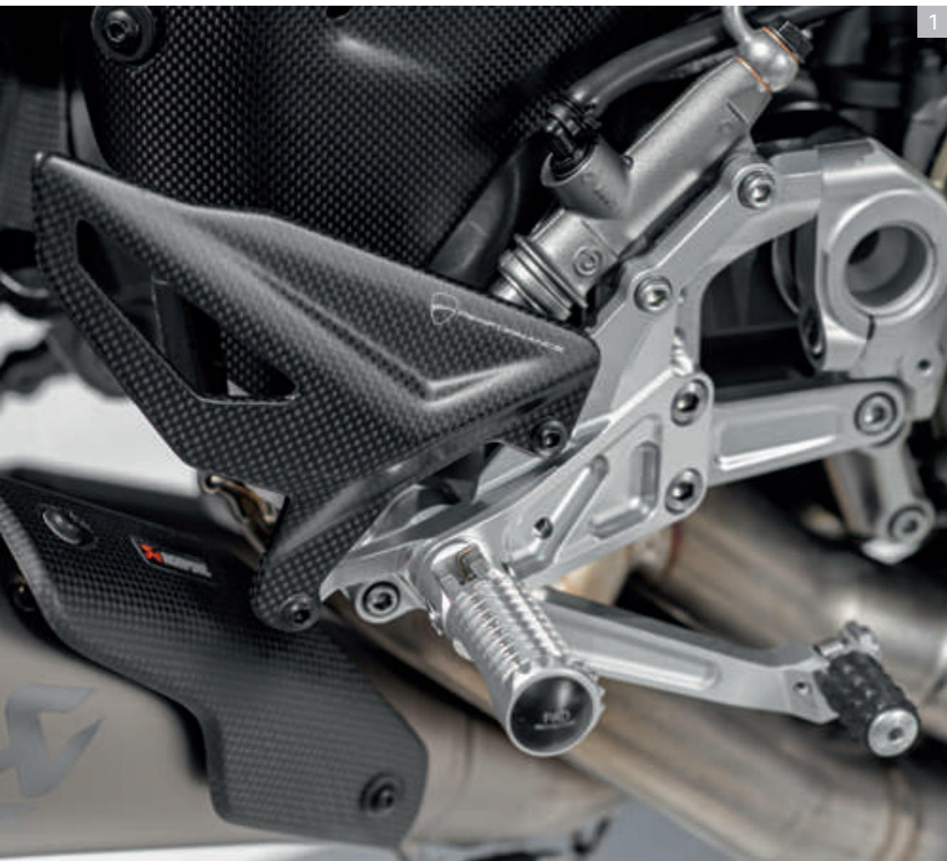
2 Protector talón de carbono. Estribos piloto regulables de aluminio.
