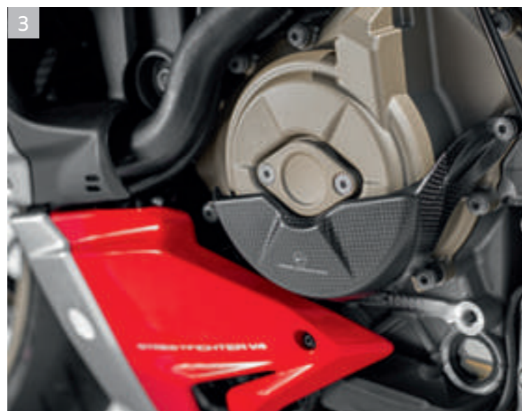
2 Depósito del líquido de embrague y del líquido de freno. 3 Protección de carbono para cárter alternador.
