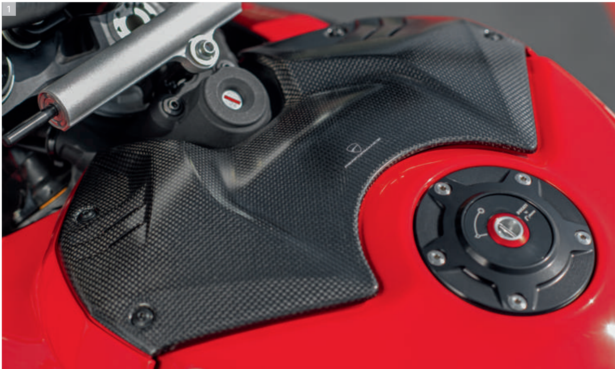
1 Cover depósito de carbono. Tapón depósito de aluminio de pieza maciza.
